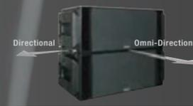
RAY SUBテクノロジーを用いたRSシリーズサブウーファーは、デジタルプロセッサー「NX242ES4」やデジタルTDコントローラー「NXAMP」との組合せにより、Omni (無指向性) モード、またはDirectional (指向性) モードの2パターンでドライブすることができます (右図参照)。また、Directionalモード時には、2つ以上のキャビネットの設置方法を変えることにより複数パターンの指向性制御も可能 (右図参照)。さらにオプション金具によるフライングにも対応し、4台以上のアレイを組んだ場合はデジタルステアリング (デジタルディレイ処理により垂直方向の指向性を制御) することもでき、より効果的に客席の後方まで低域をサービスすることが可能となります。
