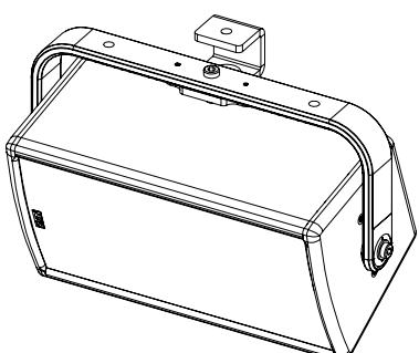
VNI-CLADAPT を天井にネジ止めします
