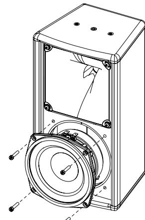
HF ダイアフラムを表出させるために、ネジ4本を取り外します。
