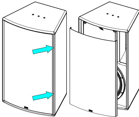
4本のネジを取り外して、LF ドライバーにアクセスします。
