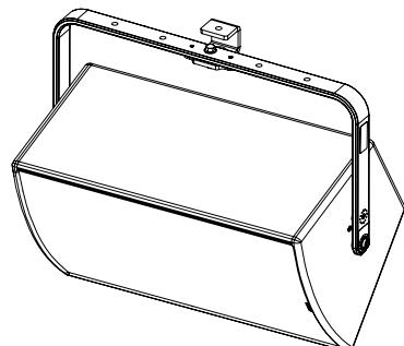
VNI-CLADAPT を天井にネジ止めします
