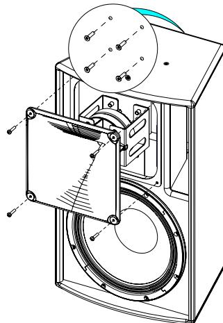
HF ダイアフラムを表出させるために、ネジ4本を取り外します。
