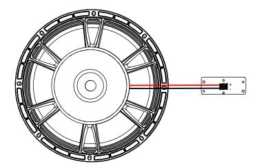
→ Pour câbler eLS600, fendre en croix la membrane du passe-fil, passer le câble au travers et réaliser la connexion sur les bornes à vis. Placer l'IPCOV.
