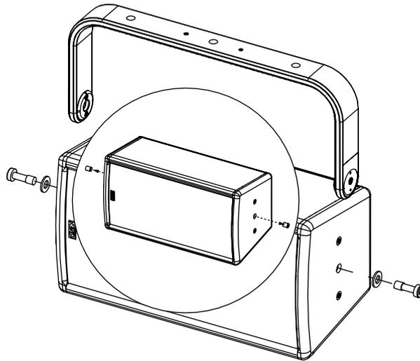
Placer l'ensemble sur CLADAPT, utiliser les 2 guides. Serrer avec la visserie fournie avec le CLADAPT.
