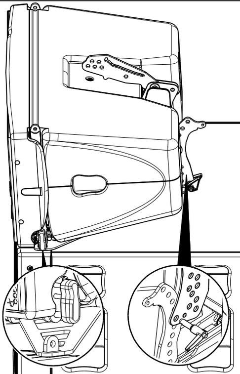
Ajuster l'angle entre le GEOM12 et le MSUB18 en utilisant la broche à billes du GEOM12 pour verrouiller la barre de liaison du MNSTKM12 et le GEOM12 (position BUMPER et angle souhaité).
