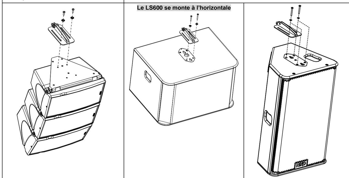
**ATTENTION : Les vis doivent être sécurisées en utilisant du frein filet de type Loctite 243™.**
