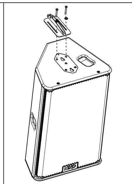
**ATTENTION : Les vis doivent être sécurisées en utilisant du frein filet de type Loctite 243™.**
