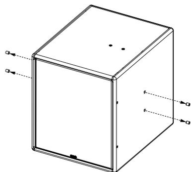
Assembler les plaques de chaque côté du eLS600 en utilisant les vis M10x20.
