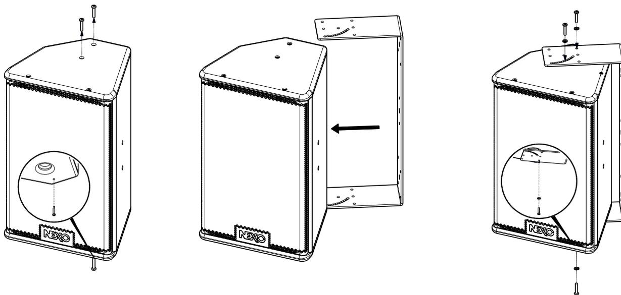
**ATTENTION : les vis doivent être sécurisées en utilisant du frein filet de type Loctite 243™**
