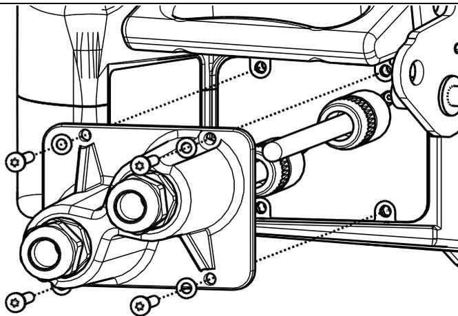
Câblage sans ressortie : monter le presse-étoupe en insérant le joint (Ø25) et le bouchon (M25). Présenter l'IPCOV, en le fixant avec les nouvelles vis. Serrer le presse-étoupe pour assurer l'étanchéité.
