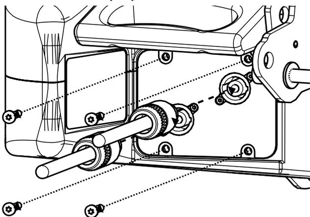
Mettre en place les joints (Ø42)
