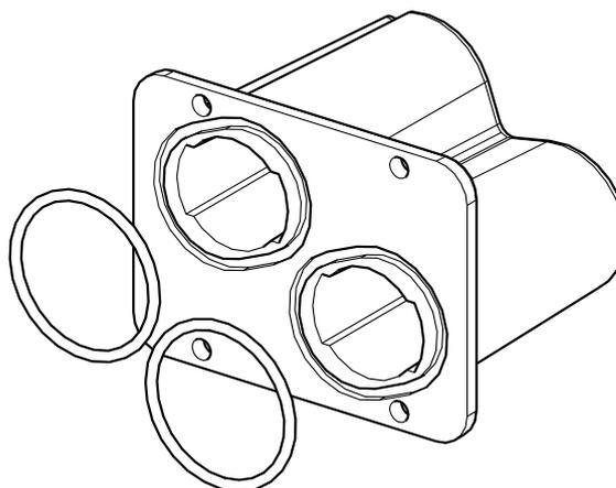
Câblage avec ressortie : monter les 2 presse-étoupes en insérant les joints (Ø25). Présenter l'IPCOV, en le fixant avec les nouvelles vis. Serrer les presse-étoupes pour assurer l'étanchéité.
