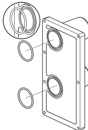
Câblage avec ressortie : monter les 2 presse-étoupes en insérant les joints (Ø25). Présenter l'IPCOV, en le fixant avec les nouvelles vis. Serrer les presse-étoupes pour assurer l'étanchéité.
