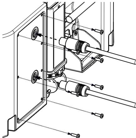
Mettre en place les joints (Ø42)
