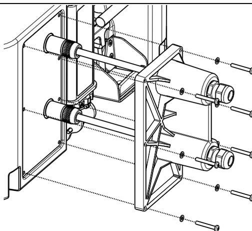
Câblage sans ressortie : monter le presse-étoupe en insérant le joint (Ø25) et le bouchon (M25). Présenter l'IPCOV, en le fixant avec les nouvelles vis. Serrer le presse-étoupe pour assurer l'étanchéité.
