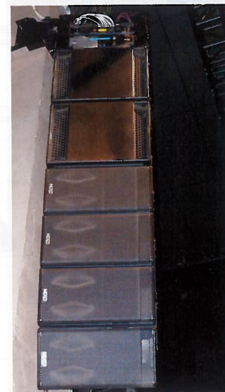
Le stack NEXO côté jardin. On distingue bien les quatre GEO en bas, le LS18 et, au-dessus, un ampli Nexo NXAMP et le processeur/matrice DME24, contrôlant tout le système via Dante.
