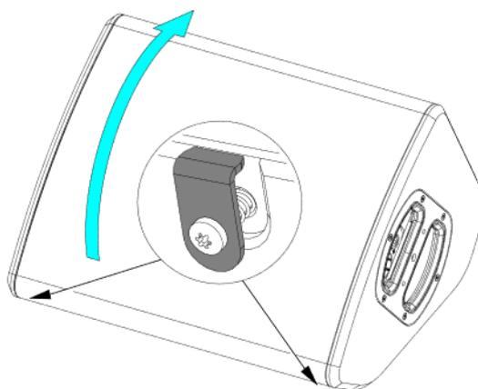
Placer le flange, orienter le si nécessaire.
