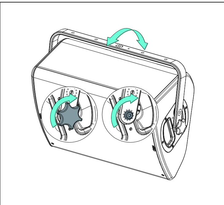
Placer sur CLADAPT, utiliser les 2 guides. Serrer avec la visserie fournie avec le CLADAPT.
