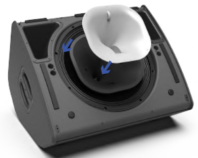
Une fois la grille retirée, des flanges magnétiques supplémentaires peuvent rapidement être installés de manière à changer la directivité pour passer de 60°x60° à asymétrique.
