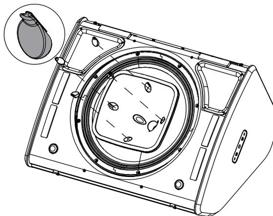
Placer le flange, orienter le si nécessaire.
