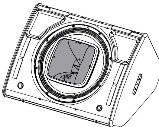
Lors du remontage de la grille, vérifier qu'elle soit bien engagée dans la lame supérieure avant de la fermer avec les crochets, visser.
