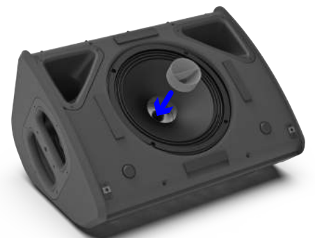
Une fois la grille retirée, un pavillon magnétique optionnel peut rapidement être installé de manière à changer la directivité pour passer de 100° x 100° à 110° x 60°
