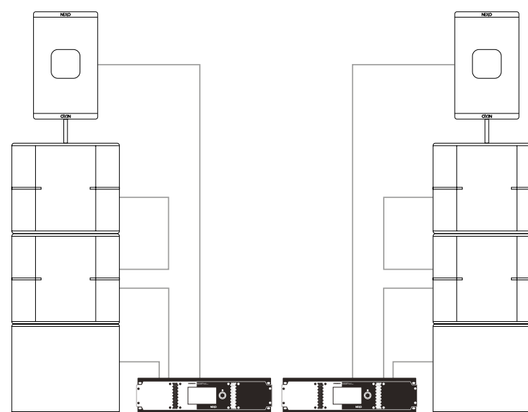
Système de façade moyen : (par côté) 1 x P15 (active) posée sur 2 x caissons L18 et 1 x caisson L18 Sub (mode cardioïde, alimentation par 2 x NXAMP4X2 Mk2
