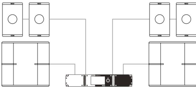
Système de haute puissance avec caissons : 4 x P8 + 2 x L15, alimentation par un NXAMP4X1<sub>MK2</sub>
