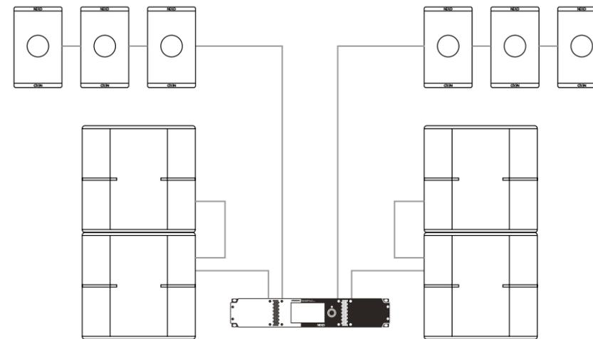
Système compact de haute puissance : 6 x P8 + 4 x L15, alimentation par un NXAMP4X2<sub>MK2</sub>
