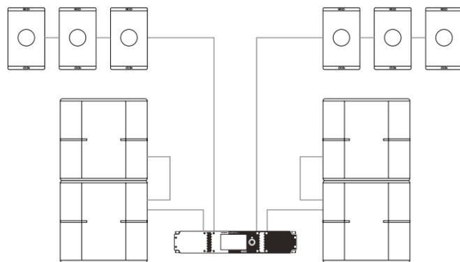
Système compact de haute puissance : 4 x P10 + 4 x L15
