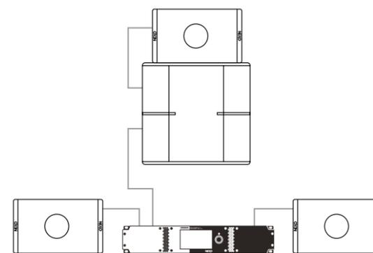
Système de retours : 1 x P10 horizontale posée sur 1 x caisson L15 (Drum Fill) + 2 x P10 horizontales en retours.
