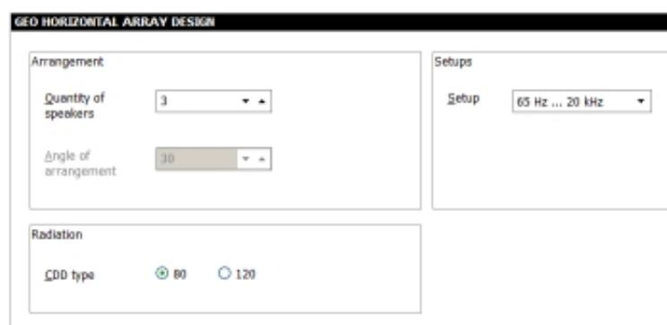
スピーカーのGEO水平ダイアログはスピーカーダイアログの一部であり、スピーカーユニットを水平方向に弧を描くように配置できます。
