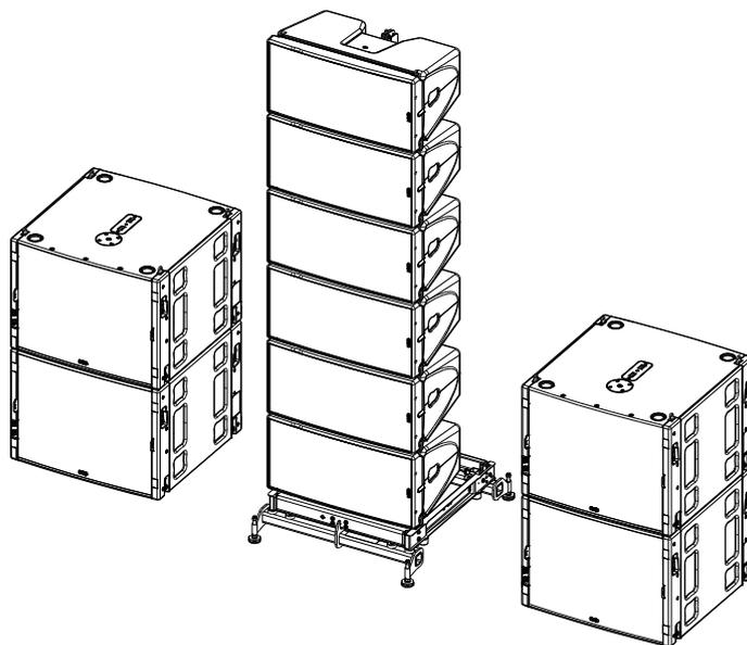
Pour des applications 'Stack' longue portée, jusqu'à 6 GEOM12, fréquence de coupure à 85 Hz pour MSUB18 (85 Hz également pour les GEOM12).
