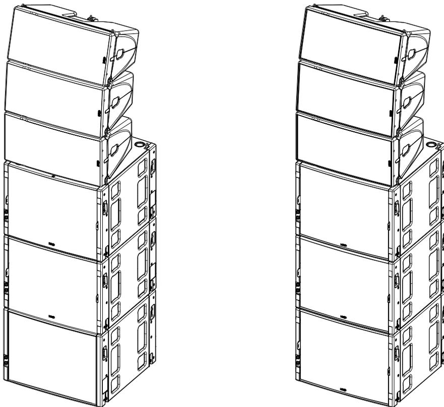
Pour des configurations 'Stack', en utilisant les MSUB18 en mode OMNI ou CARDIO (1'Back' et 2'Front') et 3 GEOM12 au-dessus, fréquence de coupure à 85 Hz (85 Hz également pour GEOM12). Un léger chevauchement pourra donner plus d'impact si nécessaire (par exemple : MSUB18 120 Hz et GEOM12 75 Hz).
