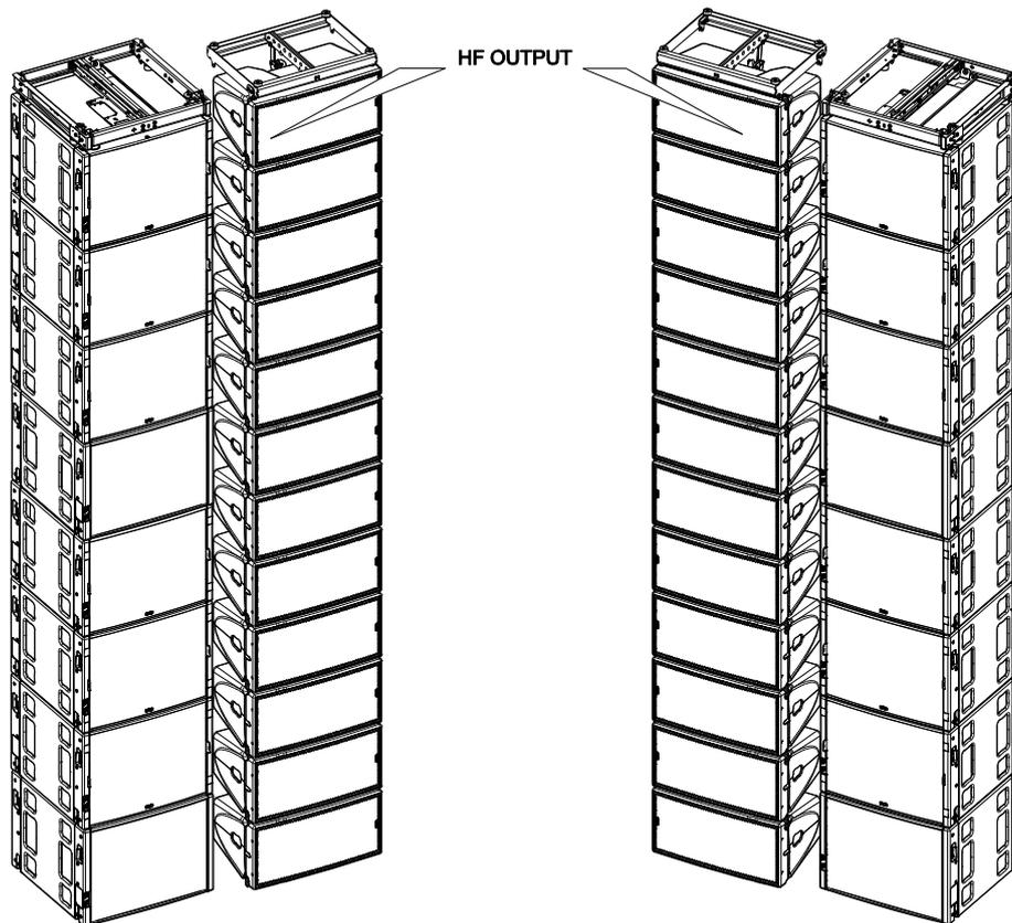
Pour les applications de très longue portée, avec des MSUB18 'Stackés' ou accrochés, nous recommandons le mode **CARDIO**, avec une fréquence de coupure à 95 Hz pour les Subs et 75 Hz pour les GEOM12 pour obtenir le maximum d'impact. Veillez à mettre les guides d'ondes HF soit à l'extérieur, soit à l'intérieur du lieu.
