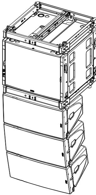
Pour ces configurations, utiliser la fréquence de coupure 85 Hz (85 Hz également pour GEOM12).
