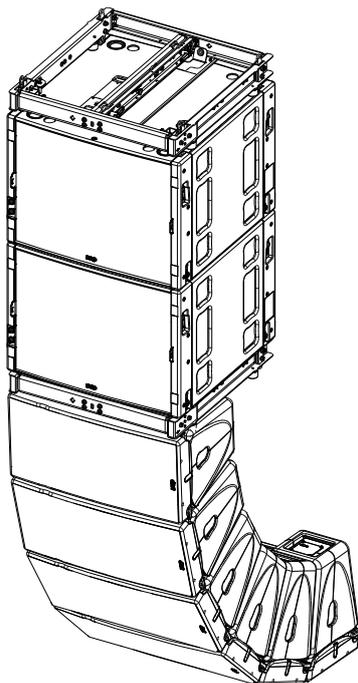
Application longue portée, MSUB18 accrochés dans la ligne, sélectionner la fréquence de coupure 95 Hz (mode OMNI).
