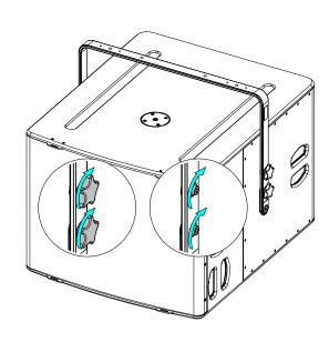
Placer sur CLADAPT, utiliser les 2 guides. Serrer avec la visserie fournie avec le CLADAPT.
