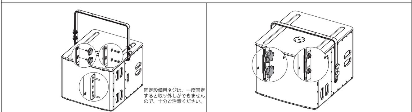
VNI-CLADAPTを2点のガイドに合わせ、VNI-CLADAPTに同梱のボルトナットで固定してください。
