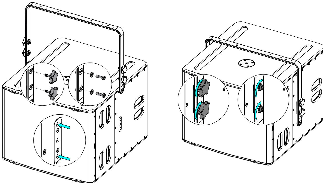
Placer sur CLADAPT, utiliser les 2 guides. Serrer avec la visserie fournie avec le CLADAPT.
