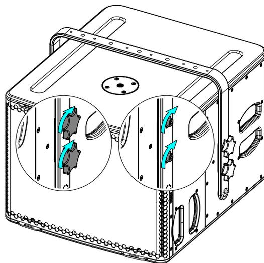
Placer sur CLADAPT, utiliser les 2 guides. Serrer avec la visserie fournie avec le CLADAPT.
