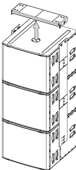
付属のM10x30ボルトx4本を使用して固定します。
