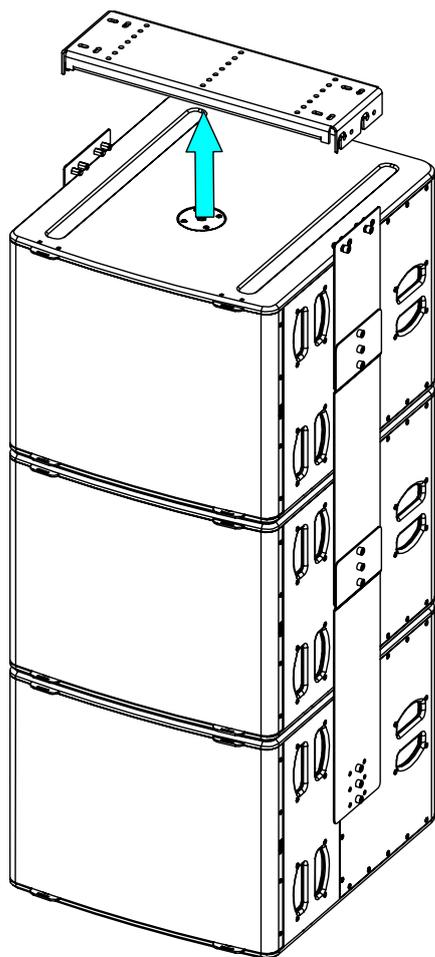
Serrer les vis. Sécuriser avec les 4 vis M10x30 fournies.
