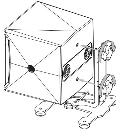
IDT-GSTK14の下にある固定ネジを緩めて、角度を調整します (-20° ~ +20°)
