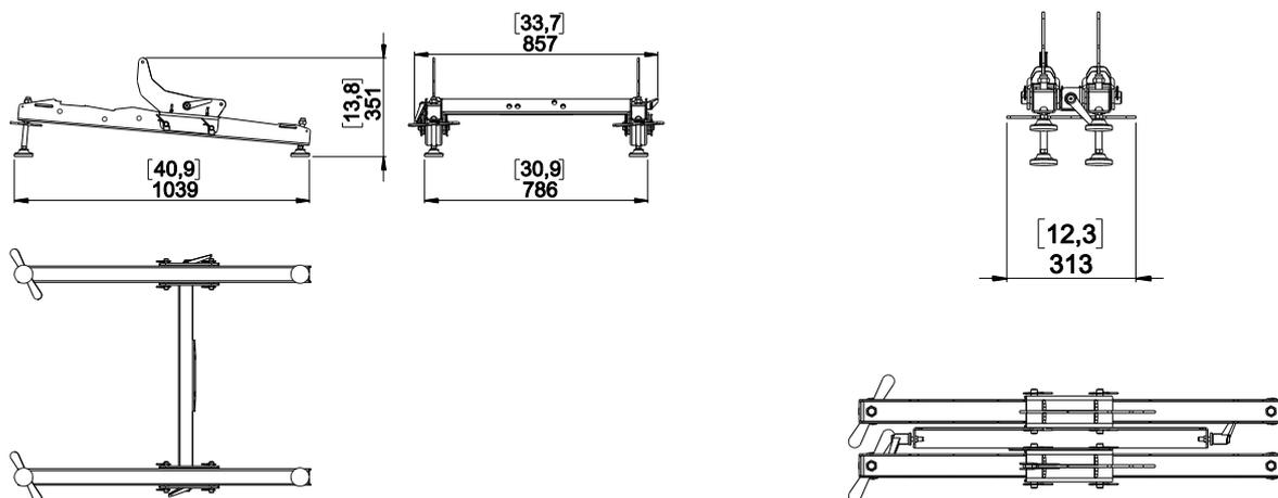
En fonction de l'angle – négatif, nul ou positif – à obtenir, il y a trois positions d'assemblage des supports X-BOW.
