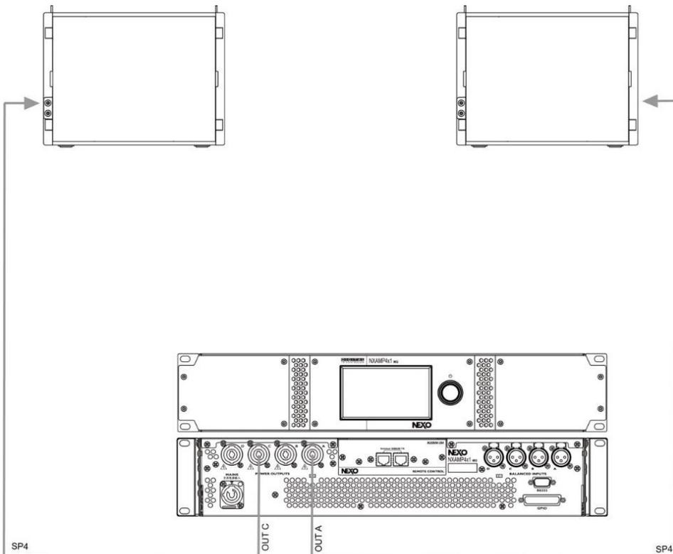
3.3 GEO M12 (mode passif) et MSUB18 / NXAMP4x1mk2 (mode stéréo bridgé)
