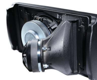
L'enceinte GEO M6 utilise un pavillon de type HRW™ (Hyperbolic Reflective Wavesource) pour un meilleur contrôle de l'énergie acoustique. L'idée est de créer une source d'ondes virtuelle, 'hors de l'enceinte', ce qui se traduit par un couplage optimal de la source d'ondes, sans interférences destructrices.
