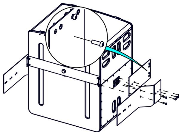
Placer l'ensemble sur la platine fixée au plafond
