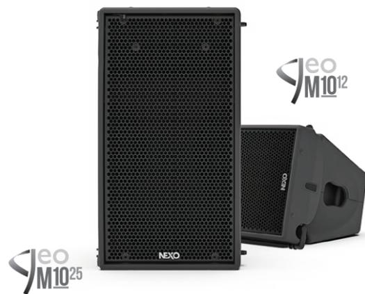
軽量ポリウレタン複合材で構成されたGEO M10ラインアレイモジュールは、幅531mm×高さ310mm×奥行404mm、重量21kgです。BEA/FEAに最適化された双曲面反射型ウェーブソース (HRW™) に、指向性位相デバイス付き10インチ8Ωロングエクスカーションネオジウムドライバーと、2.5インチボイスコイル・1.4インチスロートドライバーを搭載しています。
