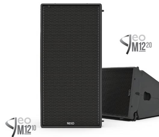
軽量ポリウレタン複合材で構成されたGEO M12ラインアレイモジュールは、幅700mm×高さ370mm×奥行446mm、重量34kgです。BEA/FEAに最適化された双曲面反射型ウェーブソース (HRW™) に指向性位相デバイス付き12インチ8Ωロングエクスカーションネオジウムドライバーと3インチボイスコイル、1.4インチスロートドライバーを搭載しています。
