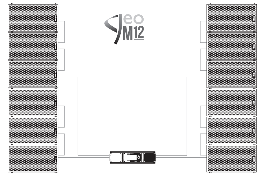
NXAMP4x4 Mk2 で左右それぞれ6台のGEO M12をドライブ
