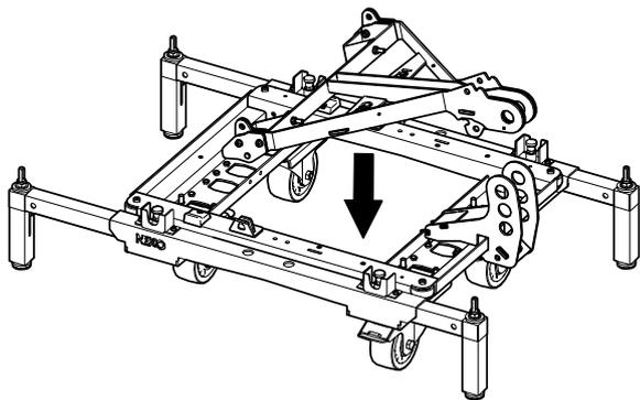
Verrouiller les 2 latch avant, Régler l'angle du bumper (3 positions, voir ci-après).
